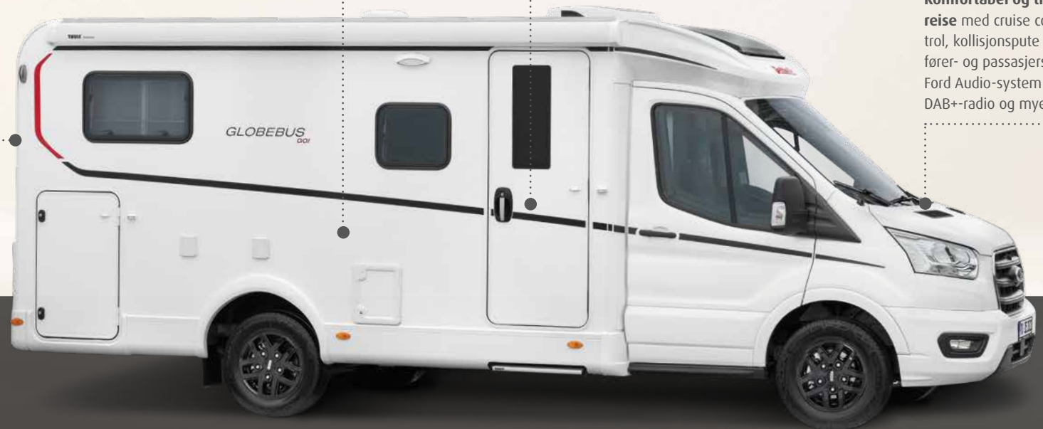
Tak, hekk og sidevegger av robust glassfiber
