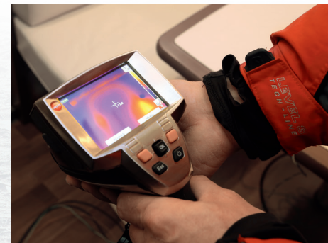
Testing av temperaturene med et varmekamera
