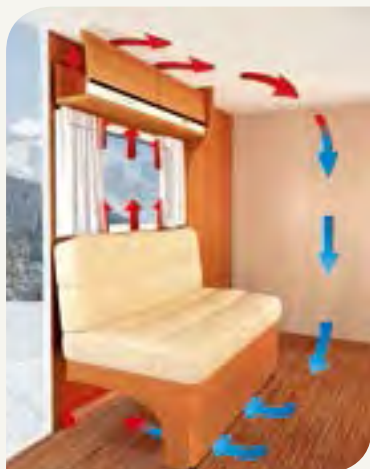
► AirPlus systemet forhindrer dannelse af kondensvand
